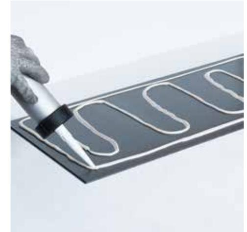
Bei Befestigung von Armaturen und Halterungen muss vollflächig verklebt werden.
