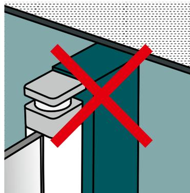
Gemäß den Vorgaben der DIN 18534 ist der Duschbereich zu einer mit CERAMIN-FLIESEN belegten durchgehenden Wand hin abzudichten. An der Stoßstelle sind die CERAMIN-Fliesen baulich mit einer Abdichtungsfuge von 5 mm zu unterbrechen und so von der restlichen Wand zu trennen.
