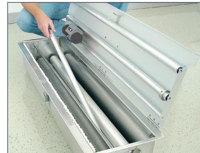
*Pour démonter l'appareil, les pieds de structure doivent être retirés des supports latéraux. Pour le transport, les pieds de structure sont introduits dans le bac d'immersion. Le couvercle fermé est bloqué au moyen du crochet de verrouillage.*
