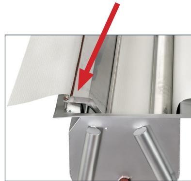
*En position de fonctionnement, le clapet racleur d'eau repose sur la bande de tissu ou de non-tissé. Un réglage selon les besoins ne peut être réalisé qu'à l'aide de la vis de réglage. Cela est notamment utile en cas :*
