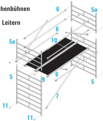
Es müssen beim Aufbau und Abbau Systembeläge oder Gerüstbohlen nach DIN 4420 (Mindestabmessung: 28 x 4,5 x 350 cm lang) als Hilfsbeläge im Höhenabstand von max. 2,0 m eingebaut werden. Diese Hilfsbeläge, als sichere Standfläche für den Auf- und Abbau, müssen nach dem Aufbau wieder ausgebaut werden. Die jeweilige Standfläche ist voll auszulegen.
