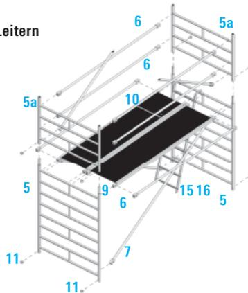
Die Rückenlehnen 6 und Diagonalen 7 sind nach dem Einbau soweit wie möglich nach außen zu schieben.
