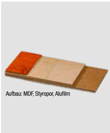
Aufbau: MDF, Styropor, Alufilm
