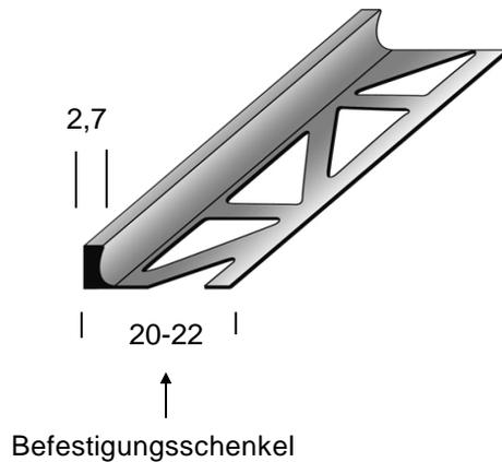
**Anwendung** : Für Verlegung von keramischen-, textilen- und elastischen Bodenbelägen
