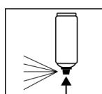
Nach Beenden des Lackiervorganges Dose umdrehen und Ventil leersprühen.
