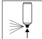
Nach Beenden des Lackiervorganges Dose umdrehen und Ventil leersprühen.
