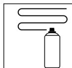
Flexible 360° C Sprühanwendung ca. 20 - 25 µm pro Spritzgang
