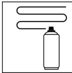
Halten Sie die Dose senkrecht und sprühen Sie dann mit einem Sprühabstand von 15 - 25 cm im Kreuzgang mehrere dünne, nebelnde Schichten. Beginnen Sie dabei immer außerhalb des Objekts.
