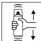
Setzen Sie einen der zwei Sprühköpfe mit einer leichten Drehbewegung wieder auf die Spraydose. Schütteln Sie diese gründlich für 1 Minute, so dass sich die Farbpigmente gleichmäßig verteilen.
