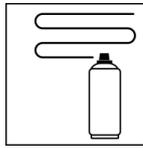
Halten Sie die Dose senkrecht und sprühen Sie dann mit einem Sprühabstand von 15 - 25 cm im Kreuzgang mehrere dünne, nebelnde Schichten. Beginnen Sie dabei immer außerhalb des Objekts.
