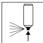
Wenn Sie die Lackierarbeit abgeschlossen haben, drehen Sie die Lackspraydose auf den Kopf, um das Ventil leeresprühen.
