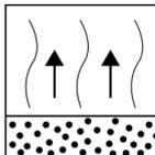
Zwischenablüftzeit: ca. 5 - 10 min zwischen den Spritzgängen / 20° C
