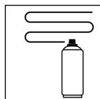
Trockenfilmschichtdicke 60 µm
