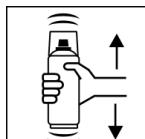
Dose nach dem Befüllen mit Lack und vor dem Auslösen 2 Minuten gründlich schütteln - vom hörbaren Anschlag der Mischkugeln an gerechnet.
