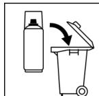
Die restentleerten Spraydosen sind als Wertstoff zu entsorgen. Dosen mit ausgehärtetem Material sind als Sonderabfall zu entsorgen.
