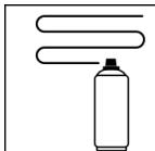
Unmittelbar nach Aufspritzen des 2K Klarlacks bzw. 2K Decklacks in mehreren leichten Sprühgängen auf die Spritznebel-Randzone des 2K Klarlacks oder 2K Decklacks aufsprühen, bis ein homogener Übergang entsteht.
