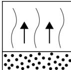
Zwischenablüftzeit: ca 5 min zwischen den Spritzgängen / 20° C
