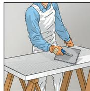
**5.** Kleber vollflächig mit Zahnschachtel/Zahnkelle auf die Varioplatte aufkämmen (10 mm Zahnung/CS).
