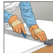
**3.** Varioplatte mit Cutter anritzen und über Kante brechen oder mit einer Säge zuschneiden.
