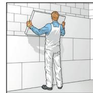
**6.** Varioplatte übereinander versetzt (mind. 20 cm) mit mäßigem Druck an die Wand anpressen. Kreuzfugen und Lücken vermeiden. Überschüssigen Kleber an den Rändern entfernen.
