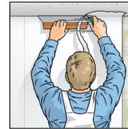
**5.** Überstände an Decken, Fußleisten, Fenstern usw. mit dem Cuttermesser und dem Tapezierspachtel abschneiden.
