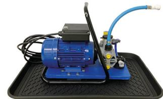
Pumpenblock 240 V mit Unterlegschale für Pumpenblock
